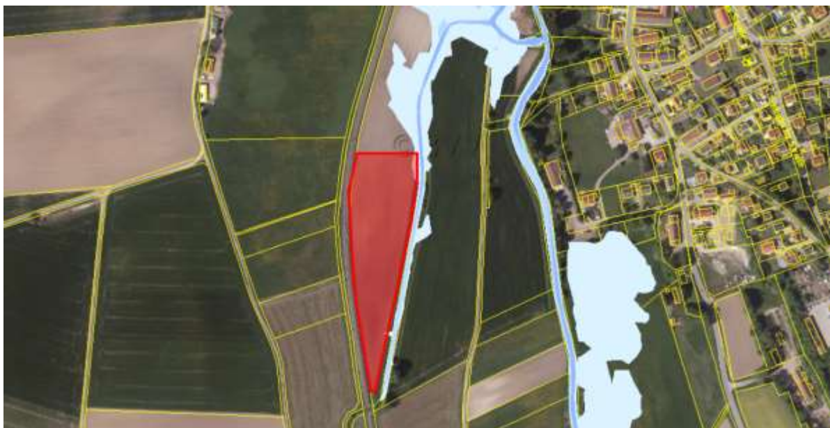
Abbildung 8: Wassertiefen für den Hochwasserfall HQ100 (Bayernatlas, 2019)
